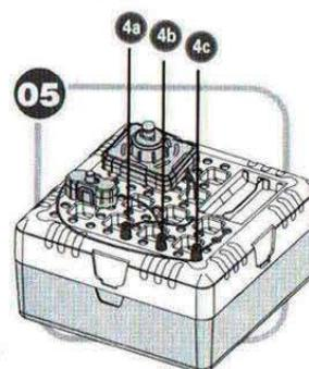
5. Подключите один провод включателя (3) к соединителю (4b). Другой провод включателя (3) подключите к соединителю (4c).
