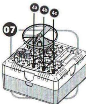
7. Соедините черный провод мотора с соединителем (4a), а красный с соединителем (4b). Теперь вы видите: соединитель (4a) подключен только к черным проводам, (4b) и (4c) – только к красным. Нажмите кнопку на включателе, и диск полетит!
