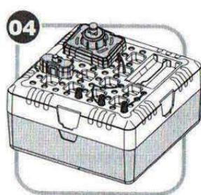
4. Соедините красный провод батареи с соединителем (4c) и черный провод батареи с соединителем (4a).
